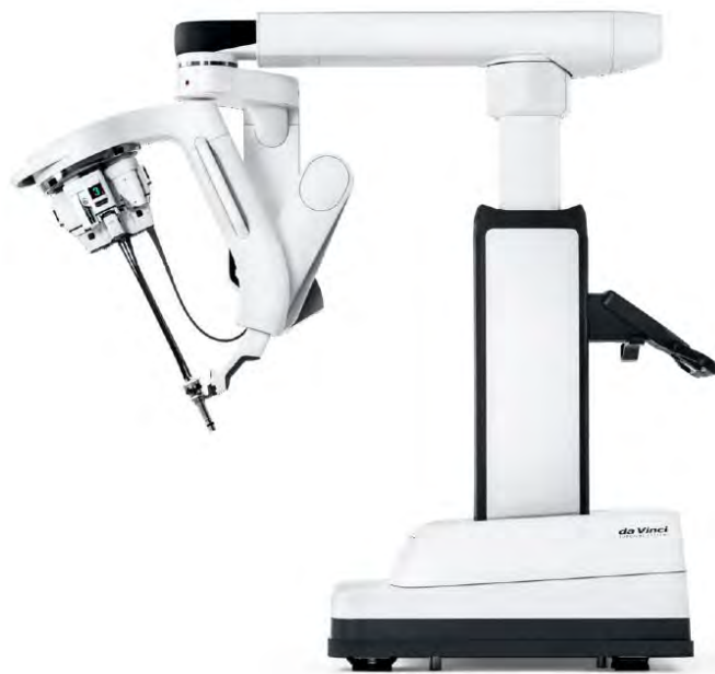
Figura 19: Carrello paziente sistema da Vinci single port® (Fonte: ab medica)
