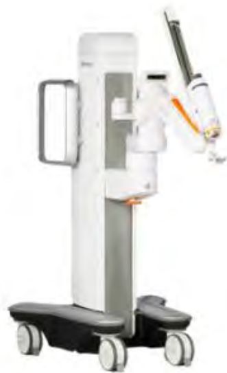
Figura 22: Carrello braccio sistema Hugo™ RAS (fonte: Medtronic)
