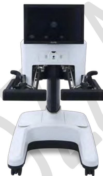
Figura 25: Console chirurgica sistema Versius® (fonte: CMR Surgical)
